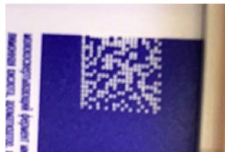
Отсутствие зоны покоя с одной из сторон
