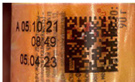
Печать кода маркировки на бликующей/светоотражающей поверхности
