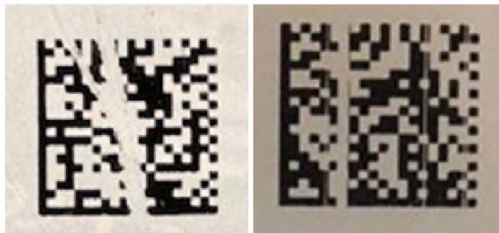
Нарушение целостности КМ*
